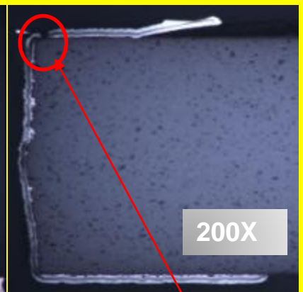
电阻镀层断裂
