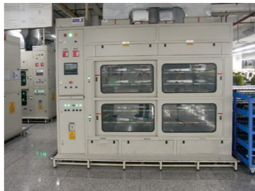
利用逆变器原理研发的能源回收器
