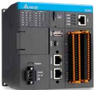
多轴同步运动控制，内置 16 组 DI 及 16 组 DO 数字接点，EtherCAT 高速运动总线，配线简易
