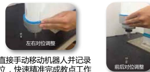
可直接手动移动机器人并记录点位，快速精准完成教点工作
