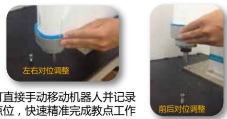
可直接手动移动机器人并记录点位，快速精准完成教点工作
