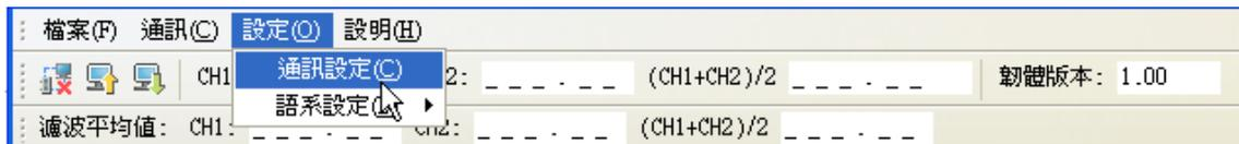
3. 出現通訊設定視窗，依照 DVP01LC 的模組設定通訊參數，通訊設定好後點選確定即跳回主畫面。
